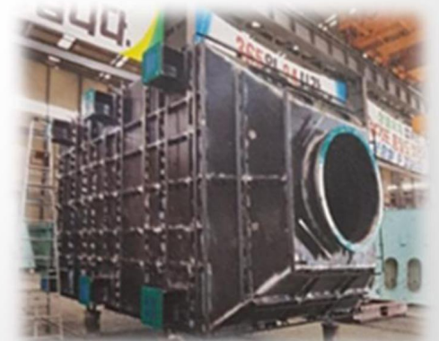
SCR 溶接作業
