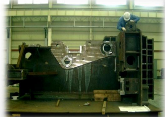
コイル設備フレーム 溶接 (Coil Equipment Frame
