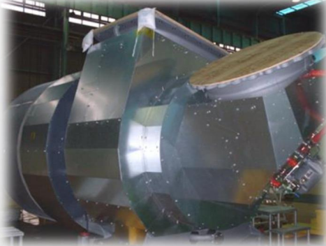
ターボチャージャー 保温 Turbocharger Insulation
