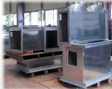
ダクト作業 (REC, CIRCLE AIR DUCT)
