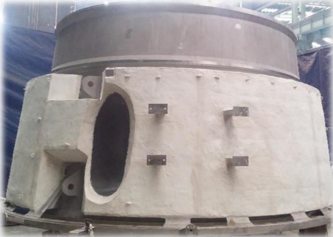
MHPS 排気 マニホルド 保温-1 Exhaust Manifold Insulation
