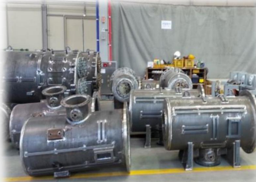
フィルターケーシング 溶接 ( Filter Casing Of BWMS )
